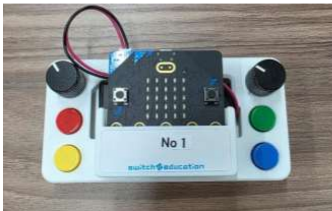
図9 micro:bit をリモートコントローラに接続した状態
